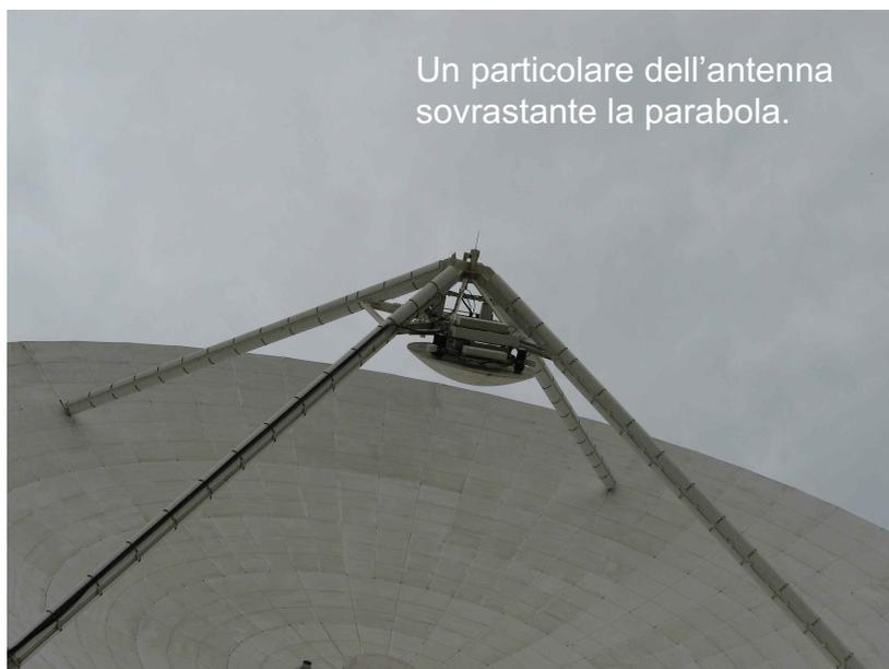
Un particolare dell'antenna sovrastante la parabola.
